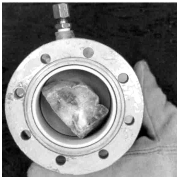
Рис. 4. Массивный природный кристалл газогидрата из керна разведочной скважины.
