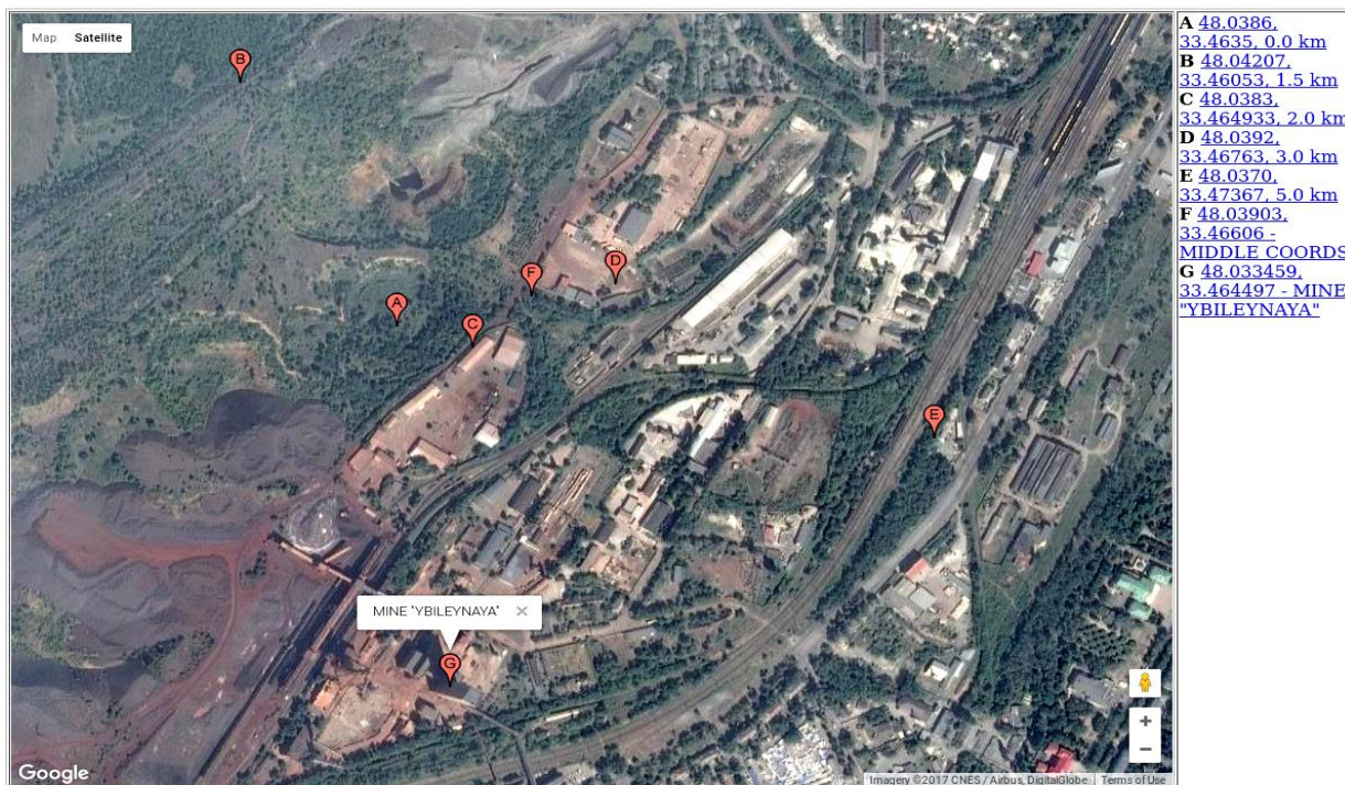
Рис. 9. Карта розташування координат епіцентрів криворізької події, розрахованих за різними значеннями глибини гіпоцентрів (A-E) та їх усереднене значення F, а також точка розташування шахти «Ювілейна» G. Координати епіцентру D найближчі до активної тектонічної структури.
