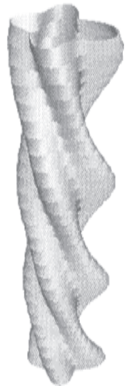
Рис. 3. Возмущение струи с закруткой (доминантная мода 4)
