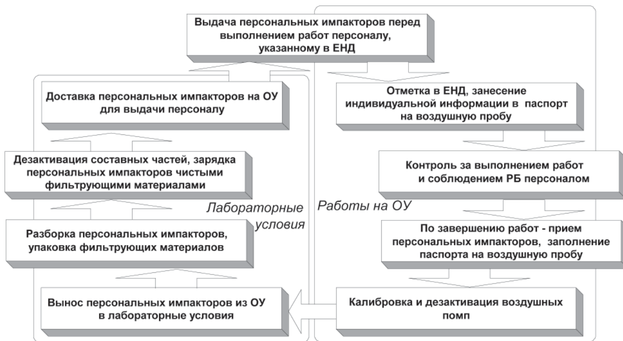
Рис. 2. Детализированная структура экспериментальной части программы с описанием последовательно выполняемых операций
