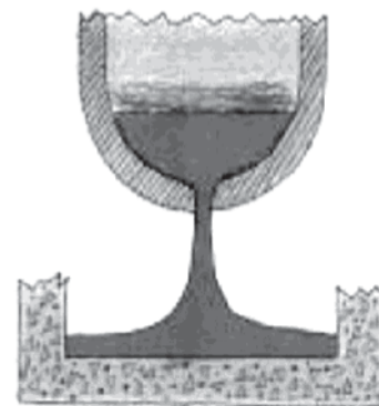
Рис. 1. Тяжелая авария на АЭС: растекание топлива в корпусе реактора (а) и в контейменте (б)
