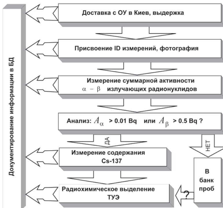
Рис. 3. Схема выполнения операций при проведении спектрометрических и радиометрических процедур
