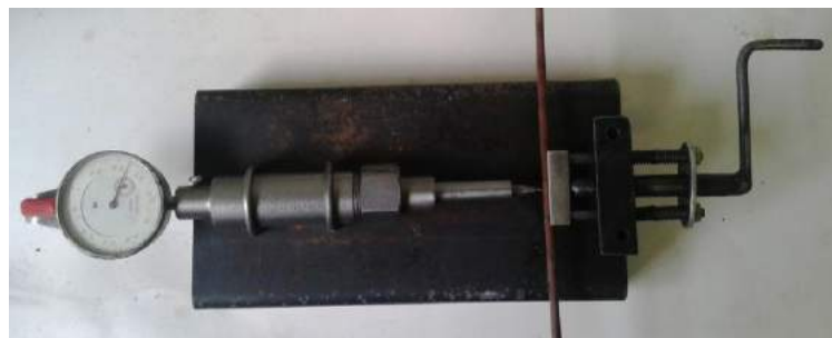
Рисунок 2 – К методике определения прочности коры при сдавливании
