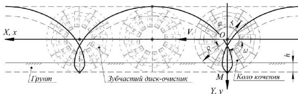
Рисунок 3 – Схема переміщення зубчастого диска-очисника сошника
