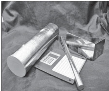
Кристали нового типу оптичного германію, легованого натрієм, з поліпшеними оптичними параметрами (патент Інституту фізики напівпровідників)
