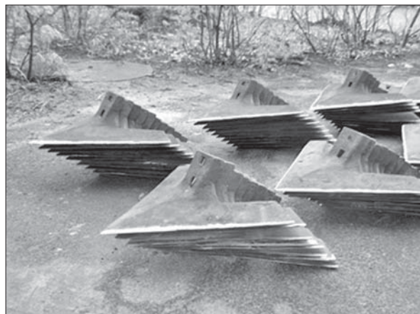
Лапи для культиваторів з бейнітного чавуну
