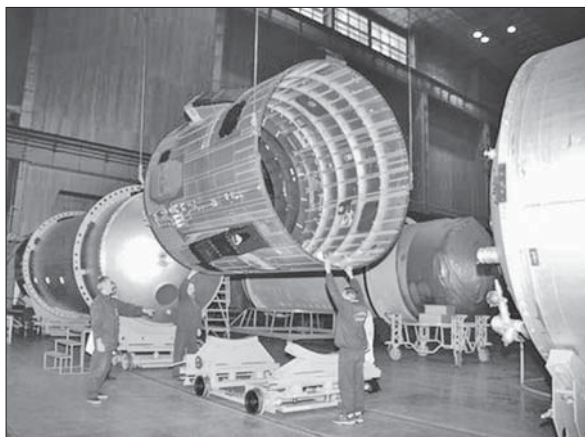
Макетирование стыковки хвостового отсека второй ступени с топливным баком второй ступени РН «Циклон-4»
