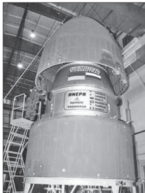
Космическая головная часть РН «Днепр» в сборочном стапеле и на испытательном стенде
