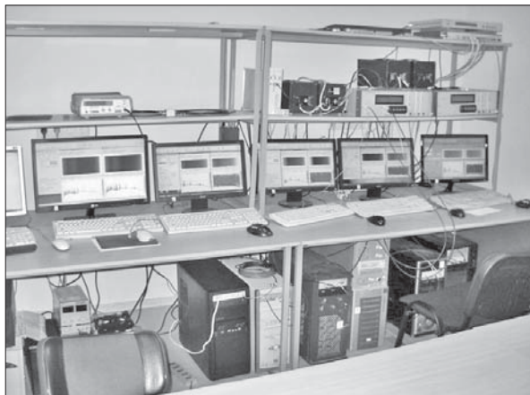
Рис. 3. Апаратний зал УТР-2 – ГУРТ із системою реєстрації нового покоління. Кількість каналів – 81920; смуга частот – 32 МГц; роздільні здатності – 0,25 і 4 кГц; динамічний діапазон – 90 дБ
