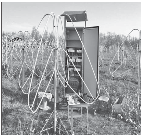
Рис. 4. Створення радіотелескопа ГУРТ; f = 8\text{--}80 МГц, N = 550 . 2013 р.
