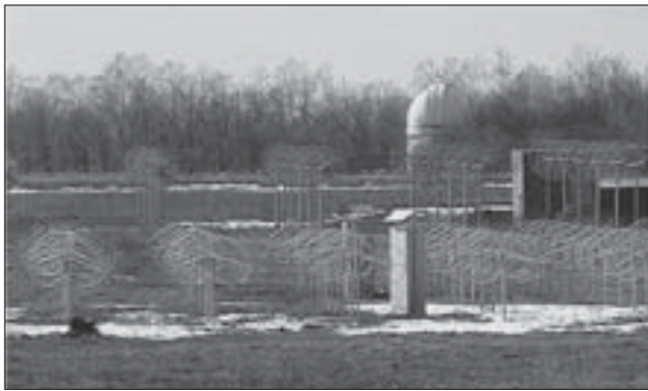
Гігантський український радіотелескоп (ГУРТ) нового покоління, f = 10\text{--}80 МГц, 2011 р.
