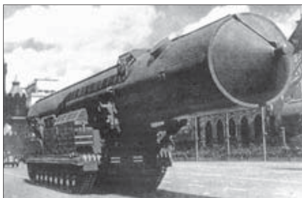
На рухомому ракетному комплексі РТ-20П «Залізна діва» в 1967–1969 роках вперше в світі було застосовано мінометний старт МБР з транспортно-пускового контейнера
