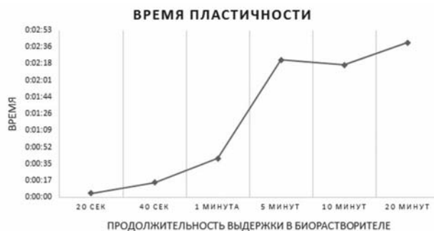
Рис. 10. Время пластичности материала (рабочее время для формирования) во влажной модели костной раны № 2 относительно продолжительности контакта с BioLinker®.
