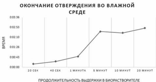
Рис. 9. Время окончания отверждения материала во влажной модели костной раны № 2 относительно продолжительности контакта с BioLinker®.
