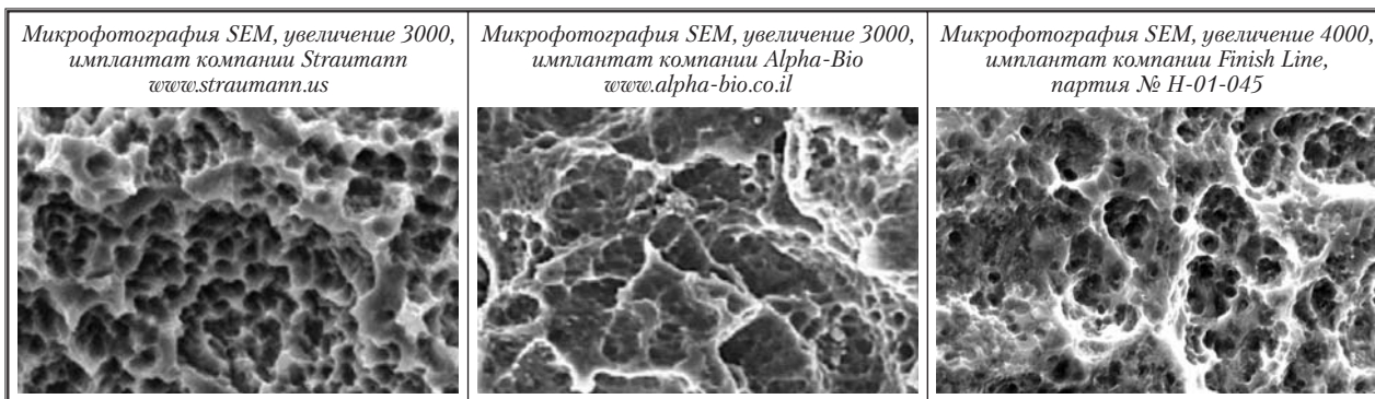
Иллюстрация основного преимущества SLA: развитая пористая структура поверхности с кратерами 2–5 микрон диаметром (представлены микрофотографии имплантатов разных компаний, полученные на сканирующем электронном микроскопе Scanning Electron Microscope SEM)
