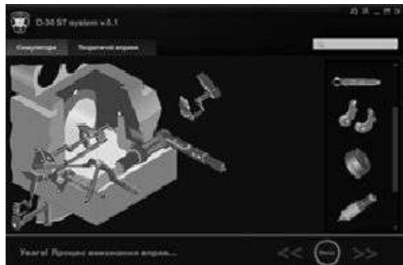
Рис. 3. Приклад практичного модуля (затвор) 122-мм гаубиці Д-30
