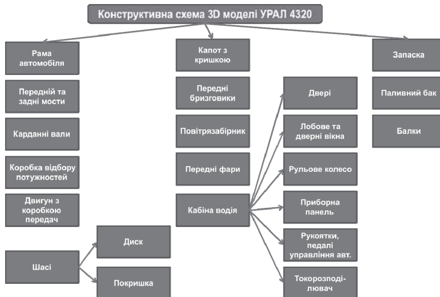
Рис. 2. Декомпозиція базової машини УРАЛ-4320 навчальної 3D моделі РСЗВ БМ-21 "ГРАД"
