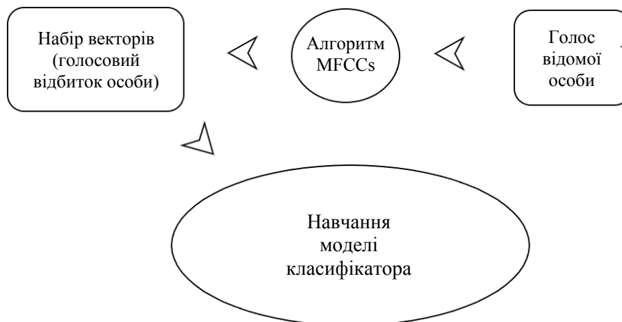
Рис. 1. Спрощена схема роботи системи в режимі навчання
