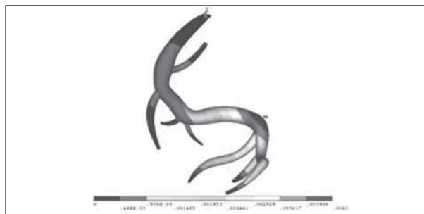
Рис. 14. Распределение перемещений узлов элементов ПКА
