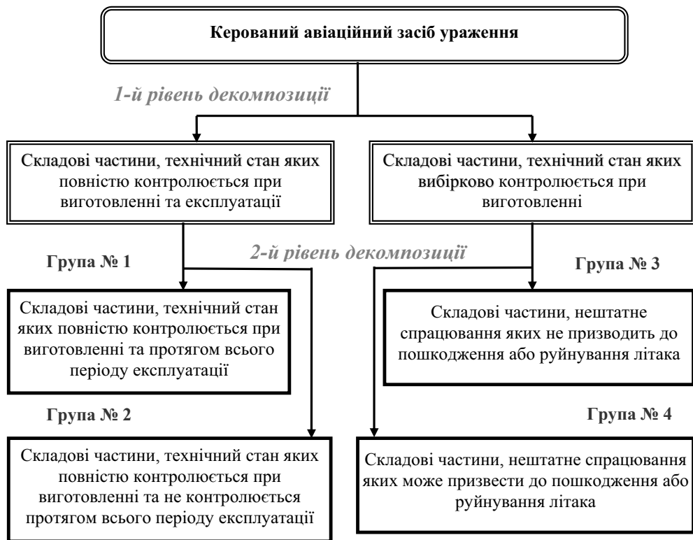
Рис. 1. Функціонально-морфологічна дворівнева декомпозиція керованого авіаційного засобу ураження на складові частини за рівнем контролепридатності та безпеки експлуатації
