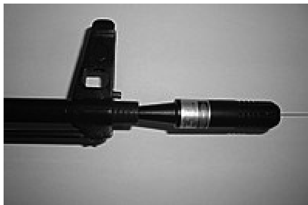
Рис. 2. Лазерний прилад «холодного» пристрілювання
