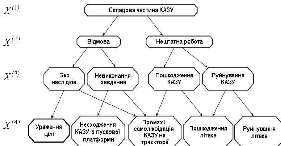
Рис. 2. Граф можливих наслідків відмов складової частини керованого авіаційного засобу ураження
