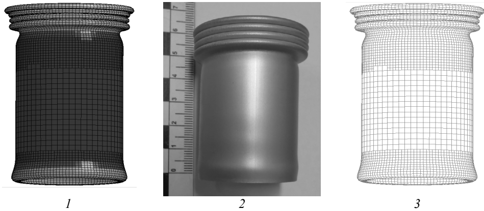
Рис. 13. Порівняння числової моделі навантаження ЕПЕ (1, 3) з результатом фізичного експерименту (2), v=4,43 м/с
