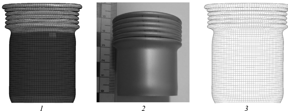
Рис. 12. Порівняння числової моделі (1, 3) навантаження ЕПЕ
