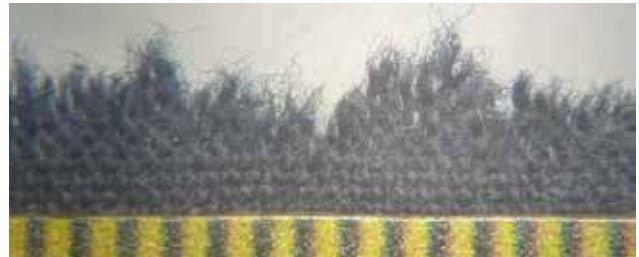
Рис. 7. Збільшене зображення кінців ниток, які розташовані на різному рівні та збільшення відстані між нитками
