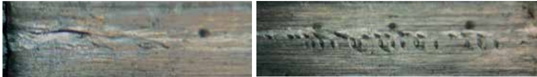
Рис. 7-9. Сліди від дії стороннього предмету на робочих штифтах циліндрового механізму замку наданого на дослідження
