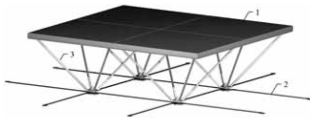
Рис. 1. Фрагмент сталезалізобетонного структурно-вантового покриття
