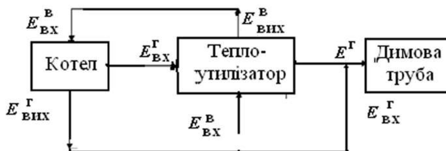
Рис. 1. Структурна схема котельної установки з теплоутилізатором при застосуванні методу байпасування димових газів для захисту газівідвідних трактів
