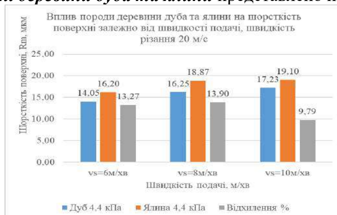
Рис. 6. Порівняння шорсткості поверхні дуба та ялини від швидкості подачі
