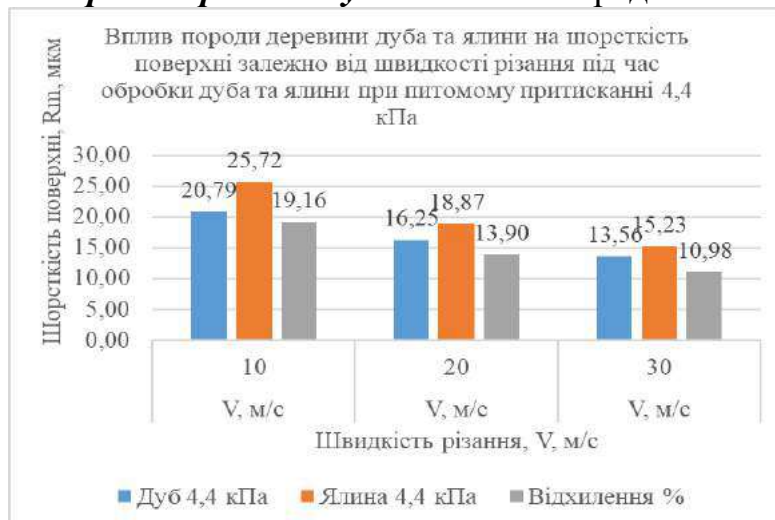
Рис. 2. Порівняння шорсткості поверхні дуба та ялини від швидкості різання
