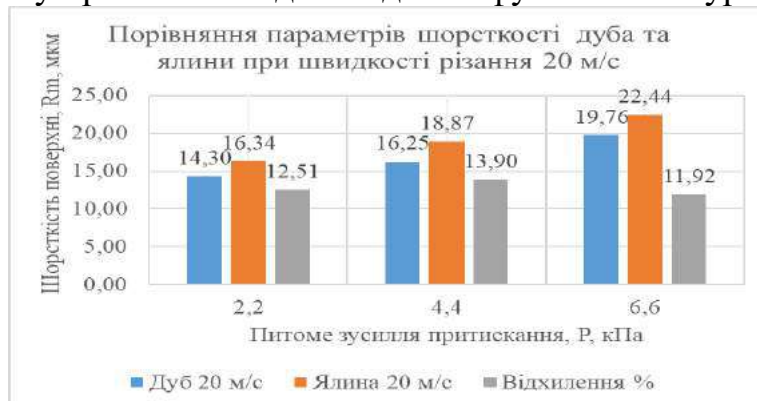
Рис. 4. Порівняння шорсткості поверхні дуба та ялини від притискання
