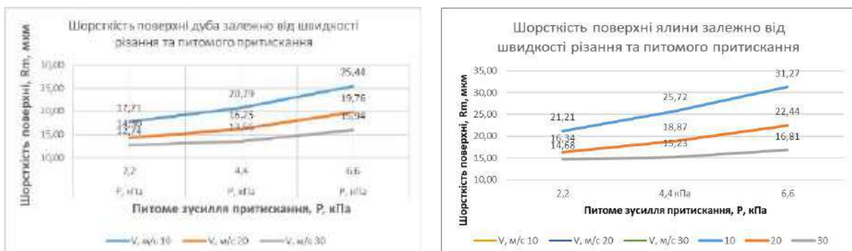
Рис. 3. Залежність шорсткості поверхні від зусилля притискування
