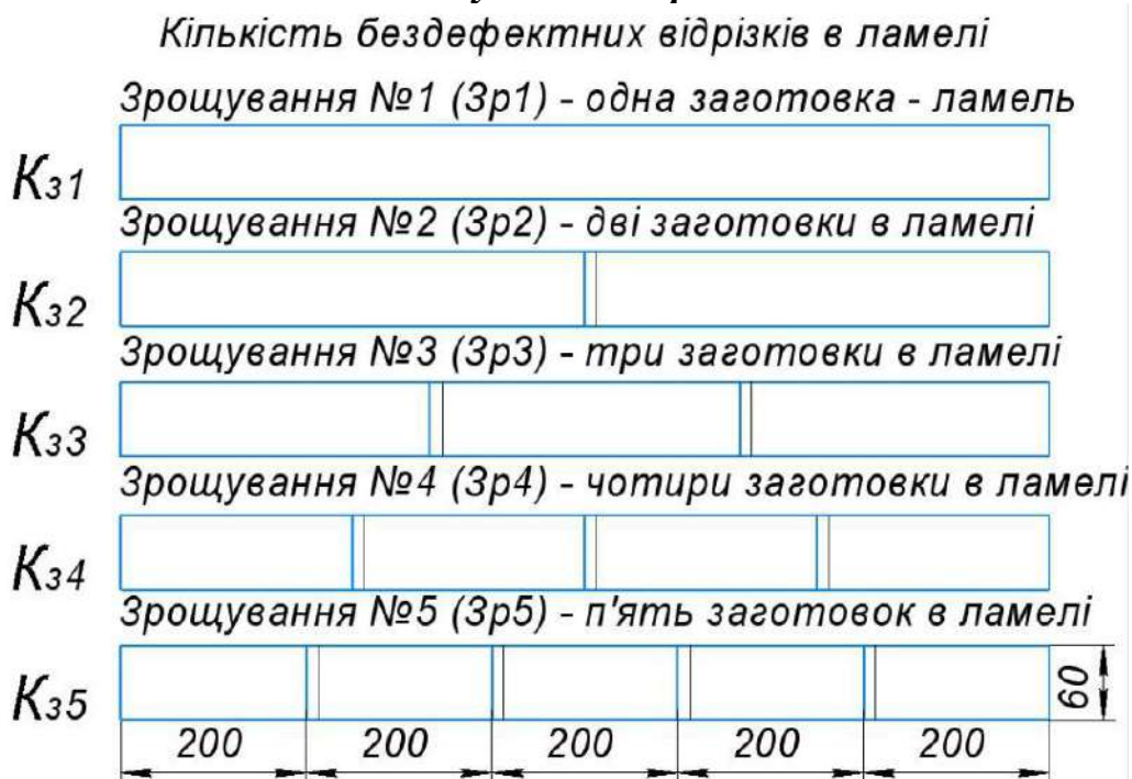
Рис. 4. Різновиди ламелей із бездефектних відрізків деревини в конструкціях МЩ із деревини бука звичайного ( Fagus sylvatica L.)
