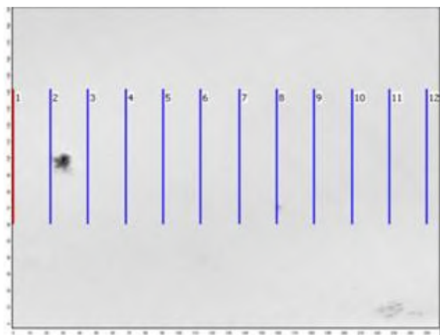
Рисунок 5 – Расположение трасс оценки шероховатости участков поверхности: размером 250×190 мкм (а) и размером 1,64×1,64 мм (б).
