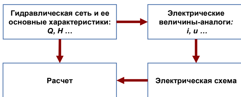
Рисунок 3 - Принцип электрогидравлического моделирования
