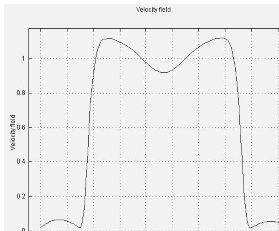
Рисунок 7 - Графік зміни швидкості повітря на виході з шафи охолодження і вході до випарника
