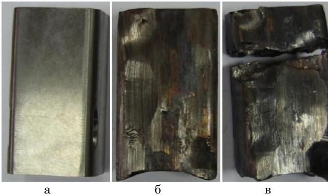
Рисунок 3 – Образец из сплава ВТ1-0 до (а) и после деформации (б), а также разрушившийся в процессе винтовой экструзии (в)
