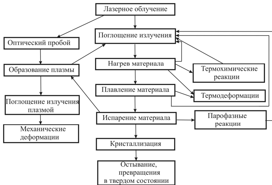
Рисунок 2 - Взаимосвязь физических процессов при воздействии лазерного излучения на материалы
