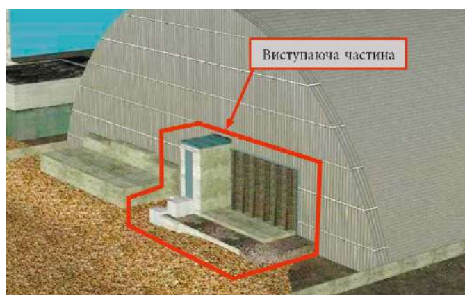
Рис. 4. Виступаюча частина об'єкта «Укриття» із західної сторони НБК після реконструкції (варіант 2з)
