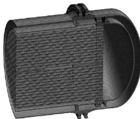
Рис. 2. Загальний вигляд металевих елементів скінченноелементної розрахункової моделі зони 1 ТОАР
