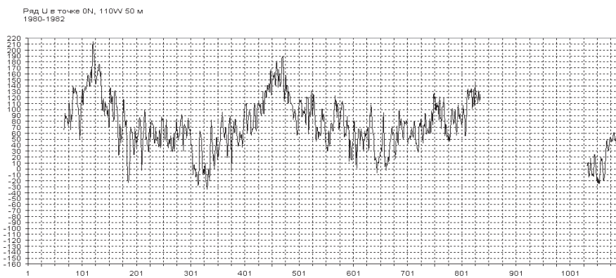
Рис. 4. Пример измерения течения на экваторе Тихого океана в пункте 0°, 110° W, на глубине 10 м., зональная компонента (W - E).
