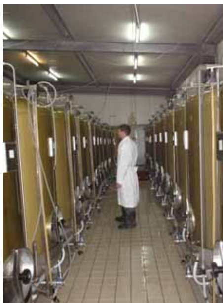
Рис. 4. Відділення доброджування у вертикальних ємностях
