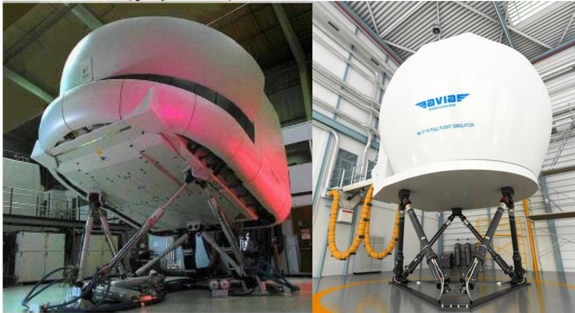
Рис. 2 а) приклад конструкції авіаційного тренажера ЛА А320 на основі гексаподу; б) загальний вид комплексного пілотажного тренажера вертольота Мі-17-1V рівня D, згідно JAR FSTD (H) [7]
