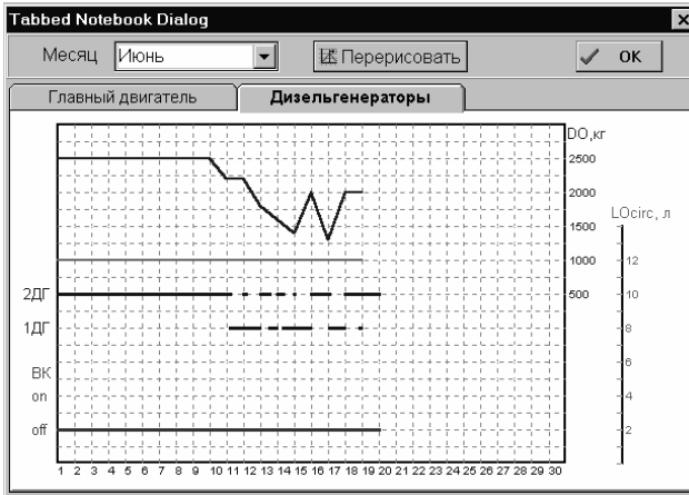
Рис. 7. Расходы дизель-генераторов и вспомогательного котла
