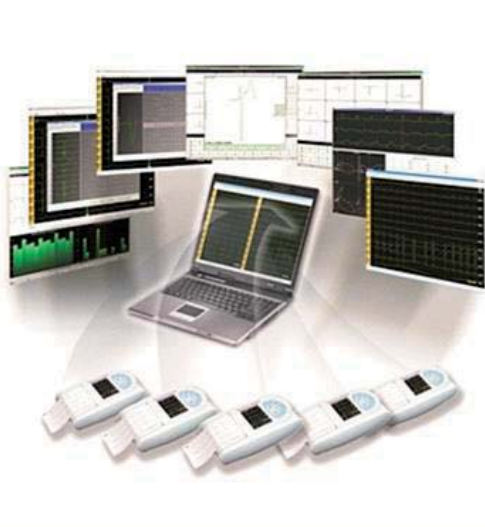
Знімок 1. а) Портативний багатофункціональний електрокардіограф «ЮКАРД — 100» з вбудованим GSM – модемом; б) прийняття та розшифровка електрокардіограми (ЕКГ).
