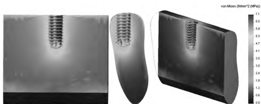
Рис. 7. Картина распределения эквивалентных напряжений в губчатой кости, МПа.
