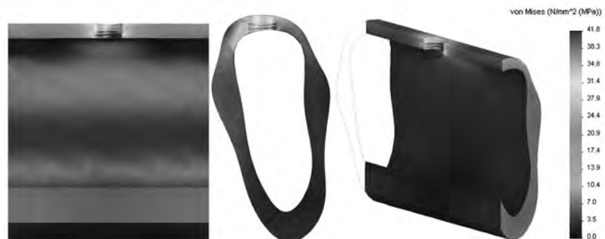
Рис. 6. Картина распределения эквивалентных напряжений в компактной кости, МПа.
