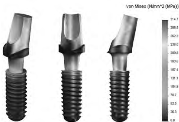
Рис. 8. Картина распределения эквивалентных напряжений в имплантате, МПа.
