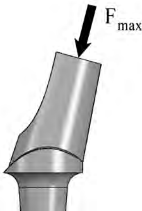
Рис. 4. Схема нагружения биомеханической системы «винтовой имплантат – челюстной сегмент».
