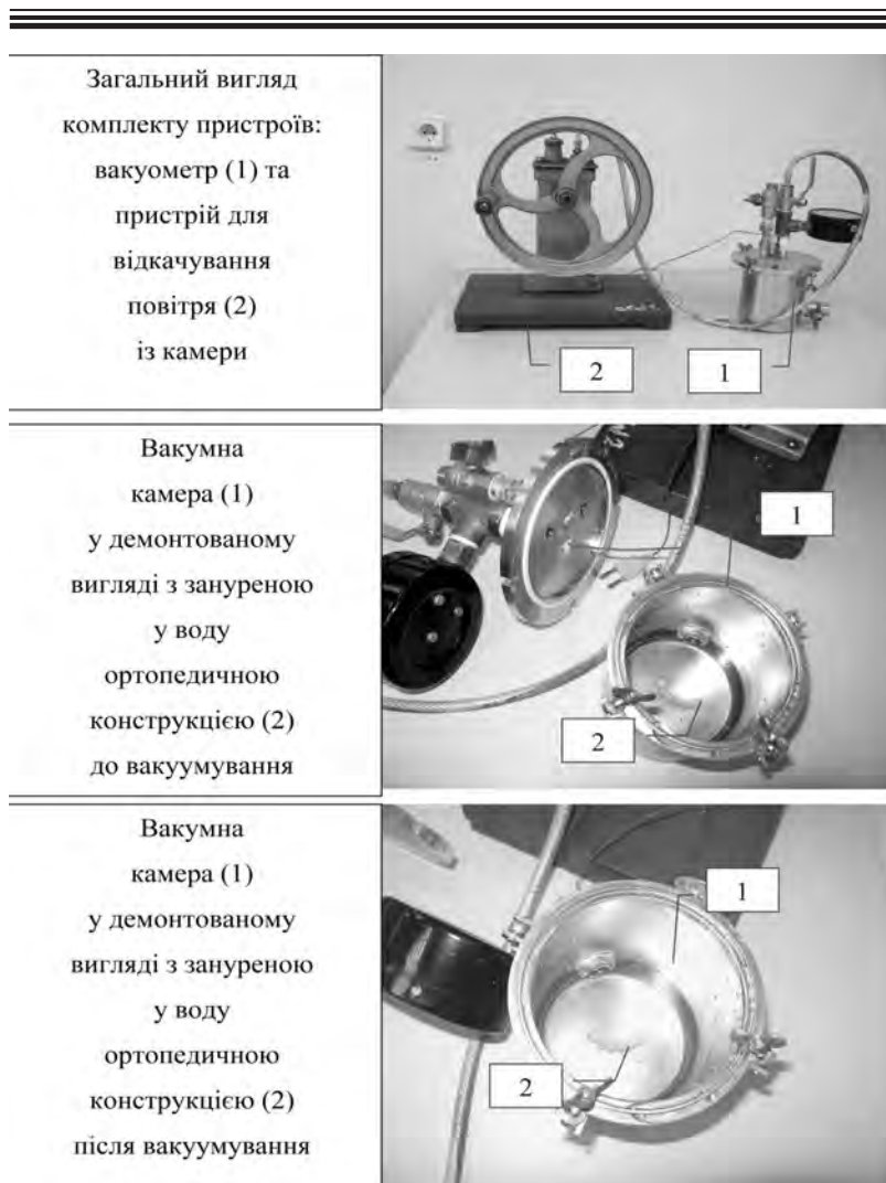
Рис. 2. Етапи технології зменшення рівня залишкового мономера у тимчасових ортопедичних конструкціях.
