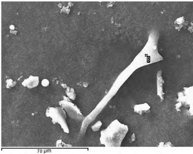
Рис. 11. Електронномікроскопічні знімки часточок та результати дослідження елементного складу фрагмента голкоподібної цирконієвої часточки в точці 8.
