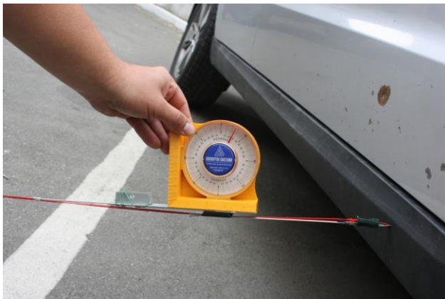
Рис. 3. Фіксування кута зустрічі снаряда з перешкодою (вертикальна площина).
