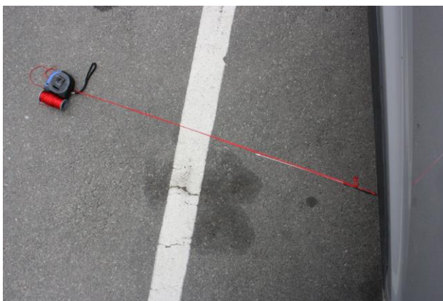
Рис. 2. Візування під час слідчого експерименту траєкторії підльоту снаряда, стріляного з гладкоствольної рушниці, до автомобіля (горизонтальна площина).
