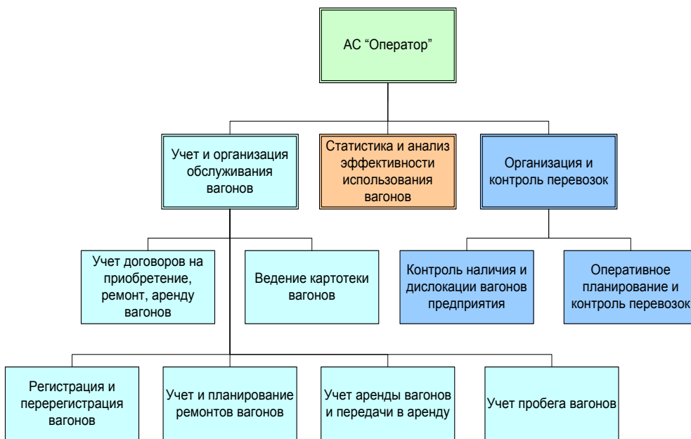
Рис. 1. Структура программных модулей АС «Оператор»
