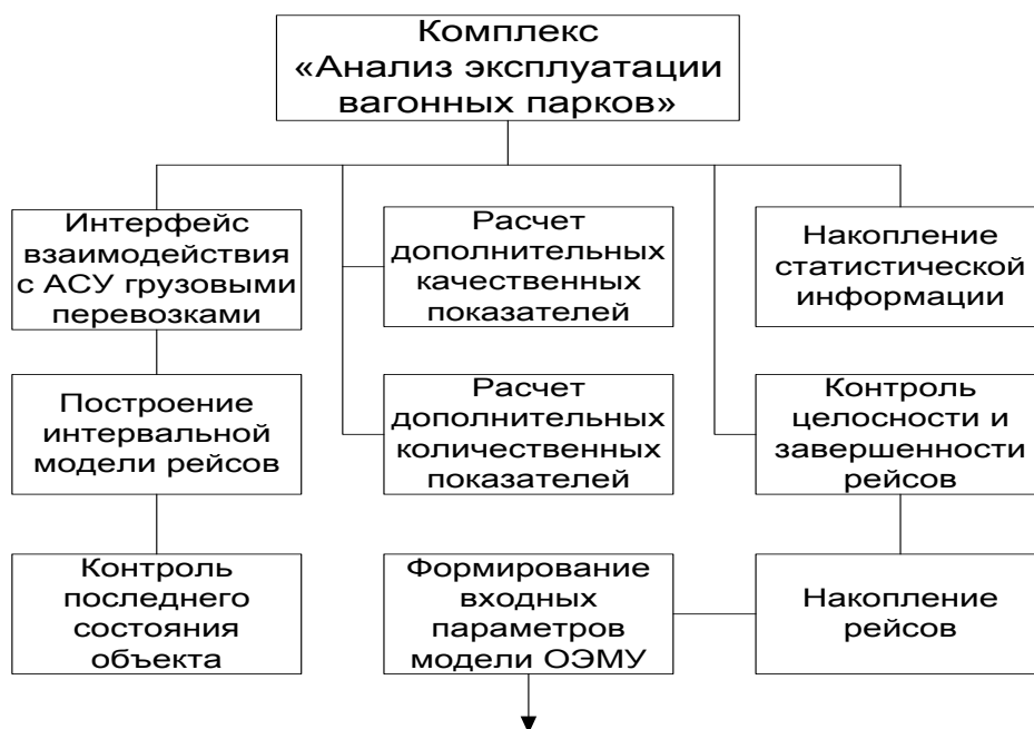
Рис. 3. Структура компонент комплекса «Анализ эксплуатации вагонных парков»
