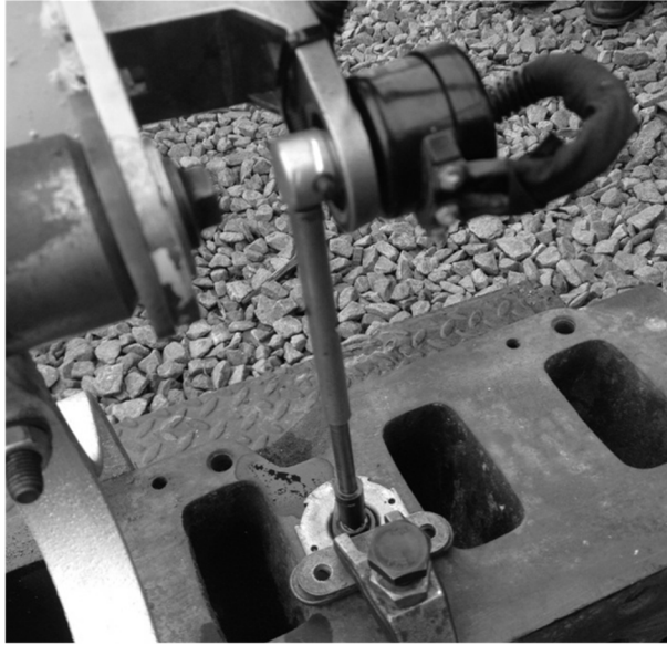
Рисунок 5 – Розміщення датчика вимірювання кутового відхилення вантажу на експериментальній установці крана-маніпулятора
