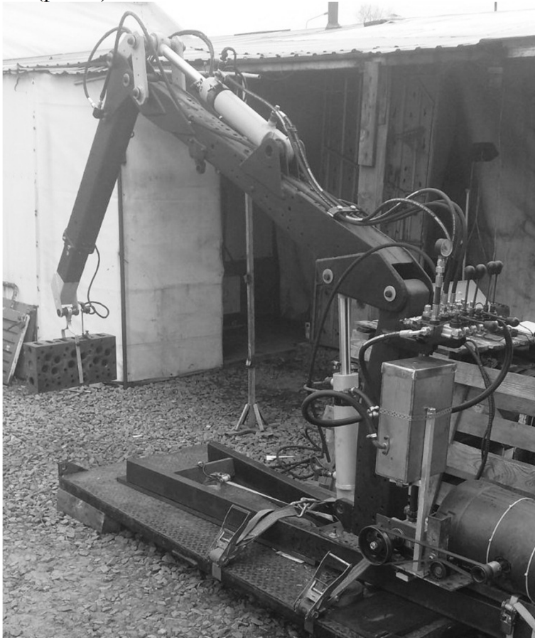
Рисунок 1 – Розроблена експериментальна установка крана-маніпулятора з гідравлічним приводом
