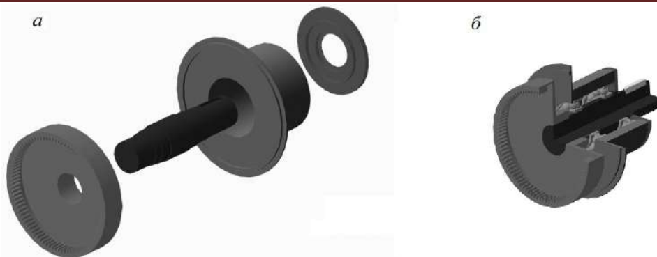
Рисунок 3 – Комп'ютерні моделі деталей зубчастого колеса – епіцикла, введеного вала, елементів корпуса
