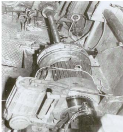
Рисунок 5 – Роздільний гідродинамічний привід механізму пересування мостового крану вантажопідйомністю 20/5 т Узловський машинобудівний завод (керівник робіт проф., д.т.н. Жермунський Б.І. виконавці доц. Пашкіна С.А., доц. Григоров О.В.)
