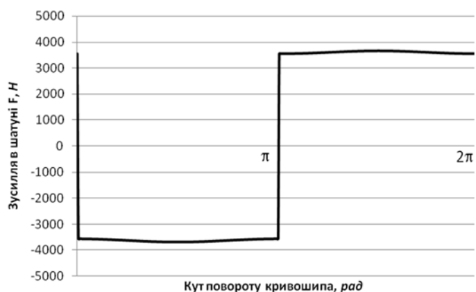
Рисунок 5 – Графік зміни зусилля в шатуні F в залежності від кута повороту кривошипа
