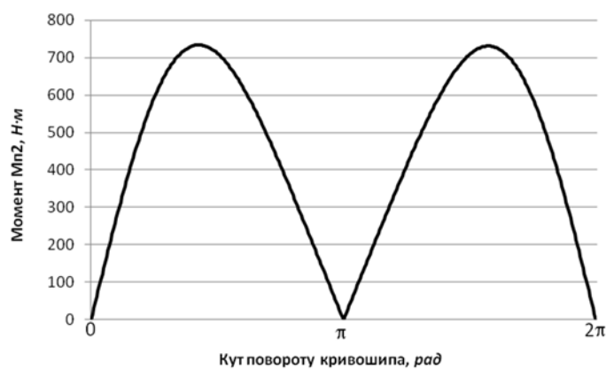
Рисунок 6 – Графік зміни моменту сил опору M_{п2} в залежності від кута повороту кривошипа
