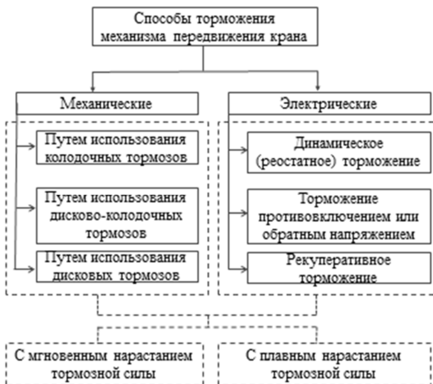
Рисунок-1. Классификация способов торможения механизма передвижения мостового крана.
