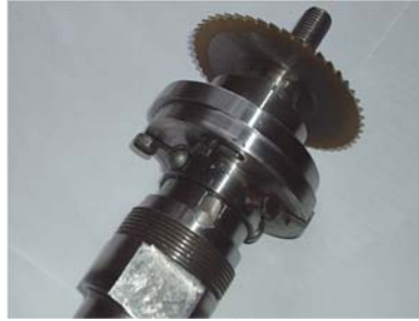
Рис.8. Дискоса фреза, встановлена зі зміщенням в радіальному напрямку для нарізання коліс за радіально-коловим способом
