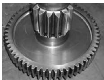
Рис.2. Блок шестерні редуктора гелікоптера до модернізації (а) та після модернізації (б)
