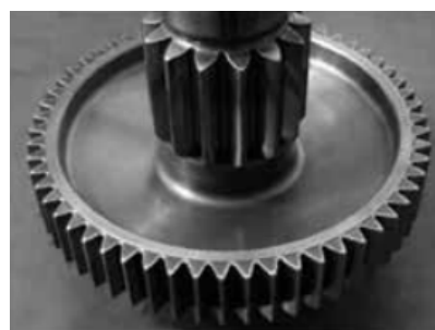
Рис.2. Блок шестерні редуктора гелікоптера до модернізації (а) та після модернізації (б)
