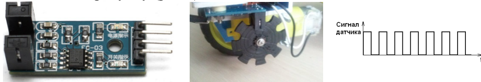
Рис.4. Зовнішній вигляд, схема встановлення, схема видачі імпульсів одометричного датчика, що встановлений на приводному поворотному колесі мобільного робота з диференціальним приводом.
