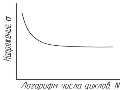
Рисунок 2 – Типичная \sigma - N кривая для стали 35ХНЛ
