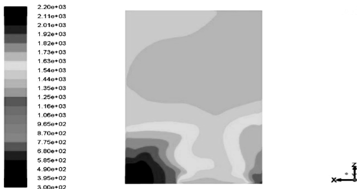
Рис. 2. Температурний розподіл у газовому просторі скловарної печі
