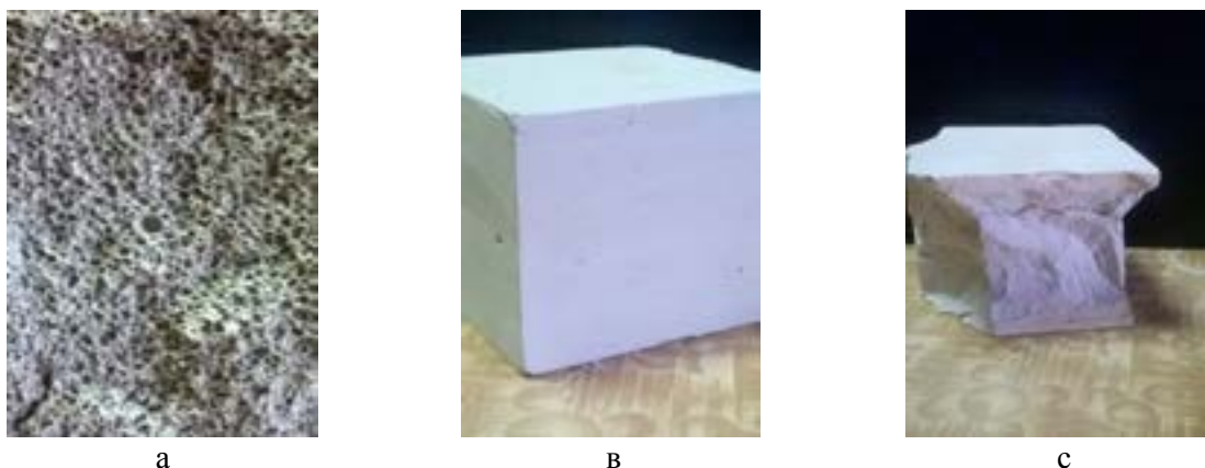
Рис. 3. Структуры традиционного автоклавного газобетона (а), микропористого автоклавного бетона снаружи (в) и внутренняя структура образца после испытания (с)
