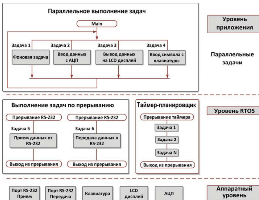
Рисунок 4 – Функциональная схема управляющей программы отладочного модуля
