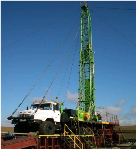
Рис. 1 – Автомобіль для ремонту нафтогазових свердловин.
