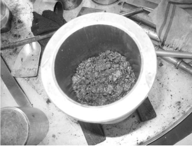
Рис. 1. Формування зразка в циліндричних формах
