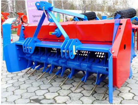
Рис. 1. Подрібнювач виноградної лози FV-1,7 (Молдова)
