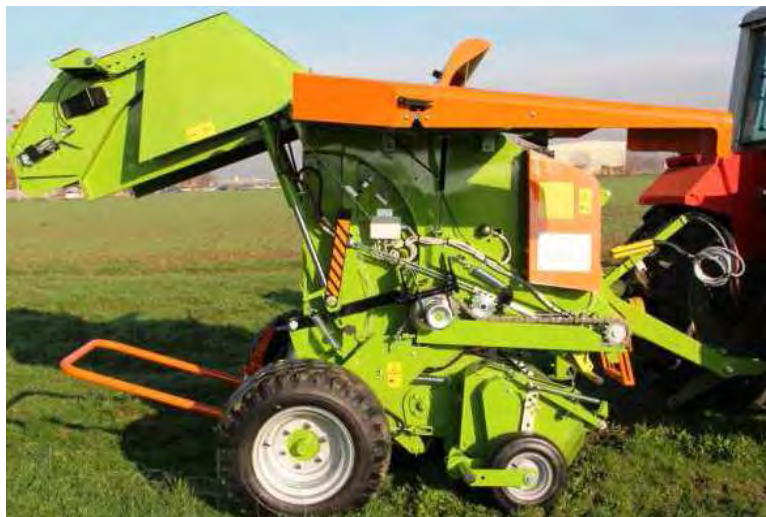
Рис. 7. Рулонний прес-підбирач R98 Wolagri
