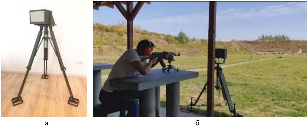
Рис.11. Радіолокаційна станція вимірювання швидкості снарядів РСВШ-112L (а) та її випробування (б) Джерело: [13–14].
