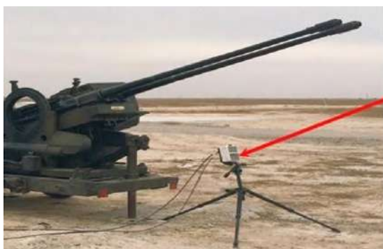
Рис.16. Відображення процесу вимірювання дульної швидкості за допомогою системи серії SL-520 Джерело: [23, С. 1].
