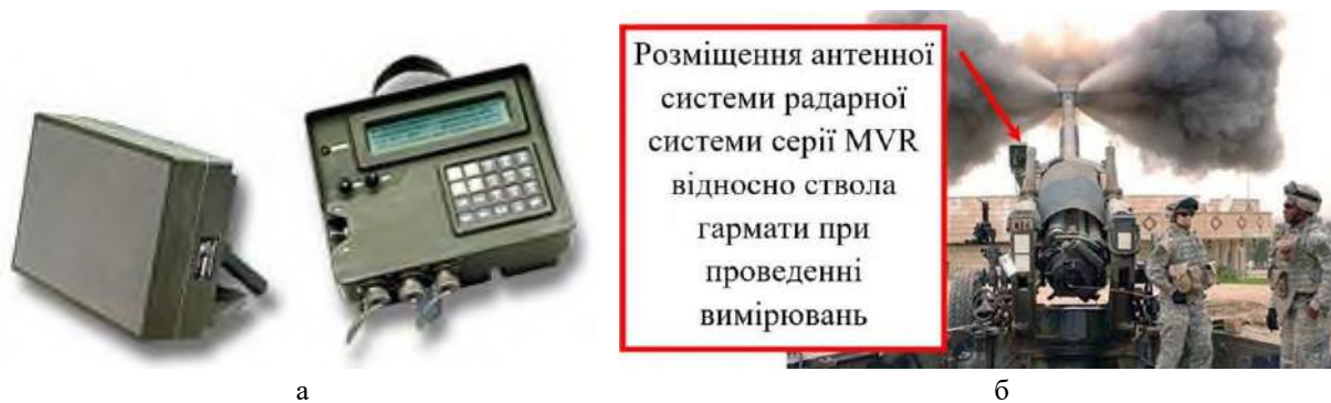
Рис.15. Відображення зовнішнього вигляду радарної системи вимірювання дульної швидкості MVR від RSL (а) та процесу проведення вимірювання (б) Джерело: [19].
