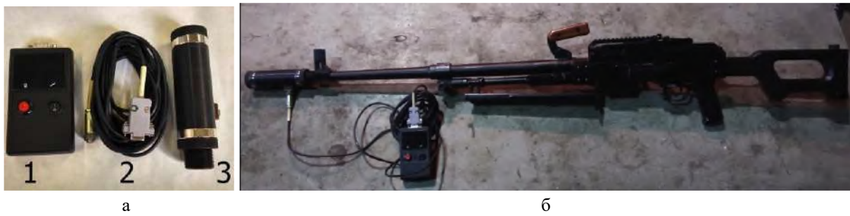
Рис.5. Відображення хронометра цифрового ХЦ-7 (а) та встановленого модуля реєстрації на стволі стрілецької зброї (б)
