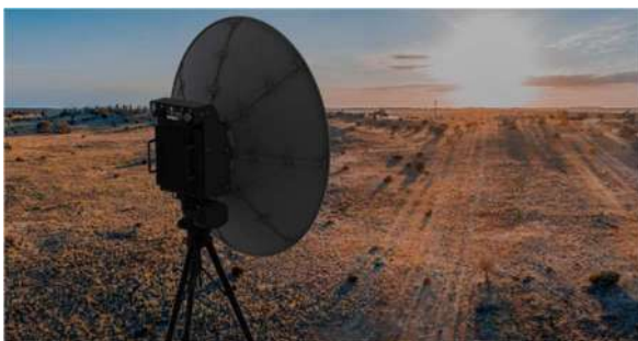
Рисунок 4 – Варіант 2. Переносна малогабаритна цифрова тропосферна станція зв'язку
