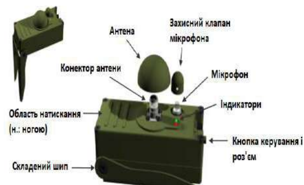
Рисунок 9 – Склад сенсорної системи Flexnet
