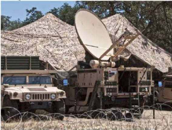
Рисунок 3 – Варіант 1. Розміщення малогабаритної цифрової тропосферної станції зв'язку на автомобільній базі
