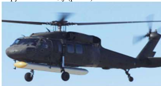
Рисунок 6 – Розміщення сенсорної системи Forester на гелікоптері
