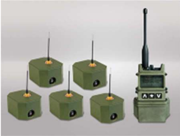
Рисунок 3 – Сенсорна система виявлення вторгнень на полі бою BAIS-i
